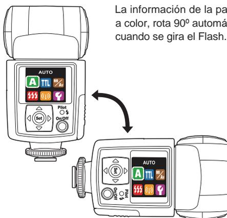
La información de la pantalla LCD a color, rota 90° automáticamente cuando se gira el Flash.
