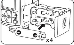
2. El compartimento de baterías está diseñado para que solo pueda entrar en una posición y evitar confusiones.
