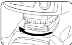
3. Deslize a base de montagem para dentro da sapata da máquina.
