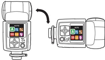
Для облегчения работы и управления вспышкой, изображение на цветном дисплее автоматически поворачивается вслед за поворотом в одну из сторон камеры, к которой прикреплена вспышка.
